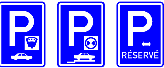
Vzorový vzhled instalovaného SDZ č. IP 13c, IP 13b, IP 12 (způsob stání musí odpovídat skutečné organizaci a orientaci vozidel a text, který bude obsahovat SDZ č. E 13, definují jednotlivé vzory pro vyplnění úsekových dodatkových tabulek).
