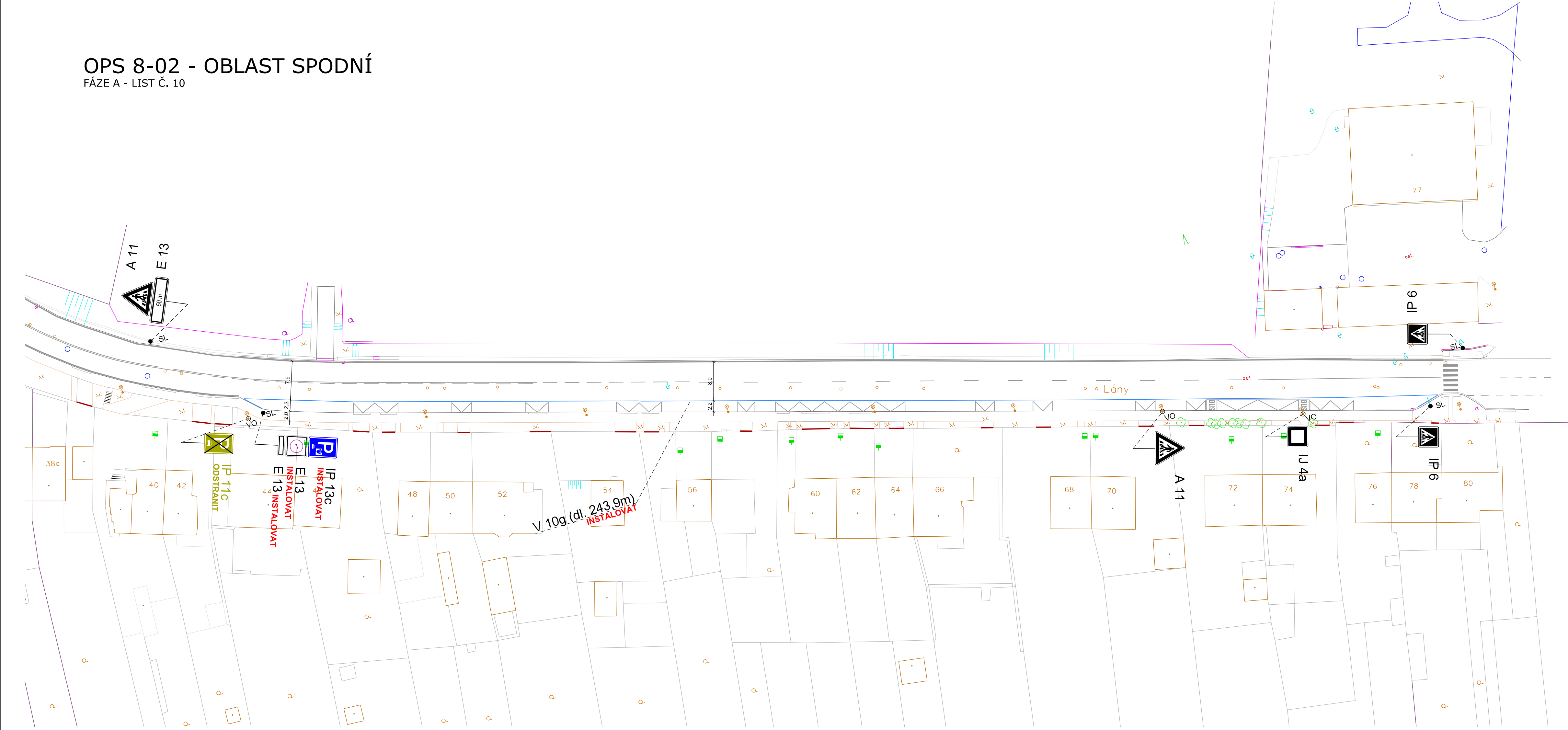
Vzorový vzhled instalovaného značení V 13, při zakončení podélného parkovacího pruhu. Všechny V 13 mají kadenci 0,5/0,5.
